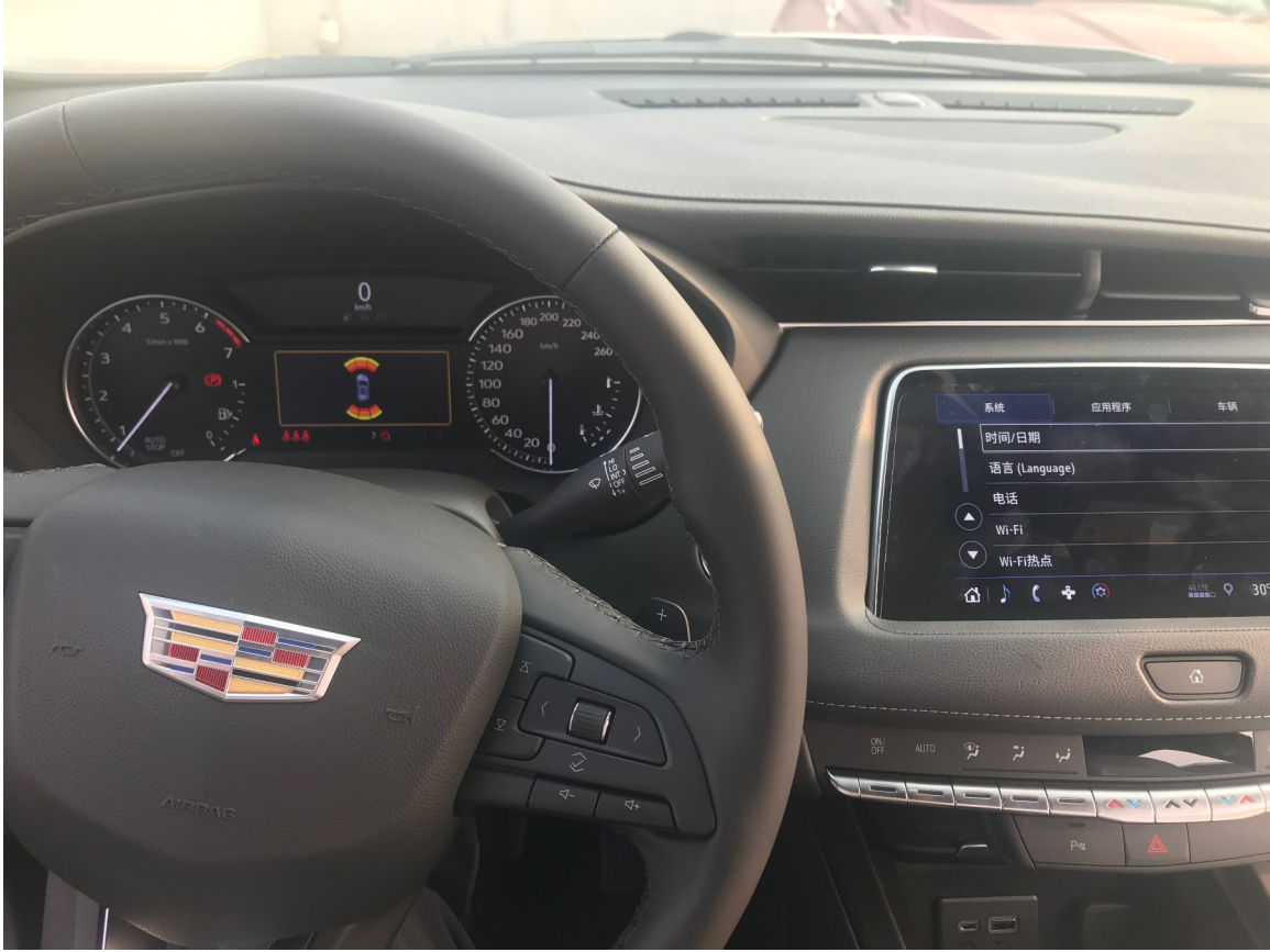
图 2 装车测试照片中雷达提示位于原车仪表。中控屏仅作为驾驶舱环境参考。
